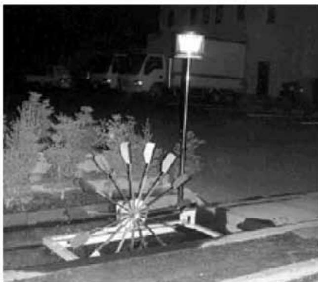
農業用水を利用した水力発電（安曇野市）
